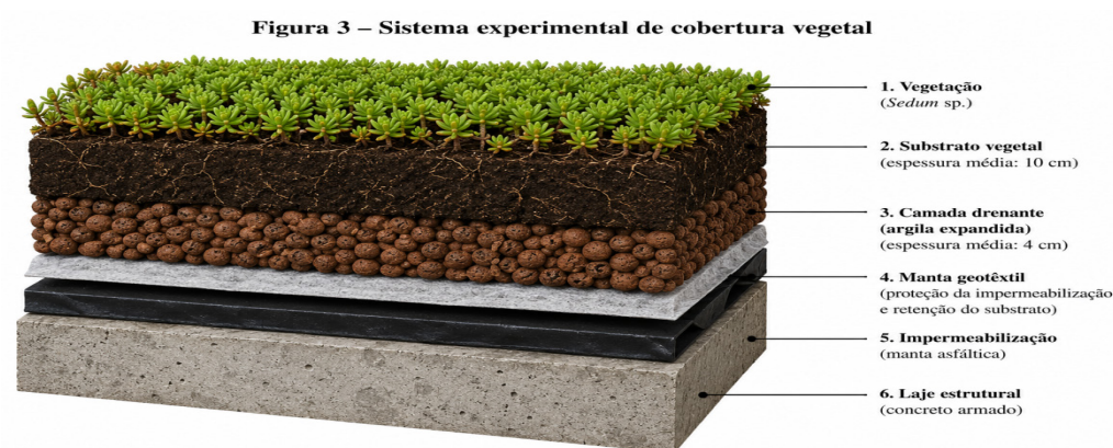
Figura 3: Sistema experimental de cobertura vegetal.
