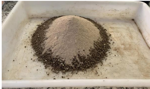
Figura 1 – Mistura de solo local com bentonita
