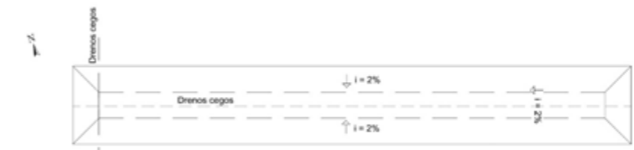
Detalhe 4 - Sistema de drenagem de lixiviado Escala 1:300
