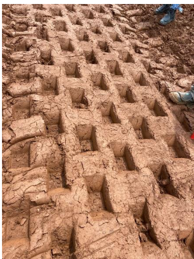
Figura 5. Rejeito sem adição de HPA pós compactação.
