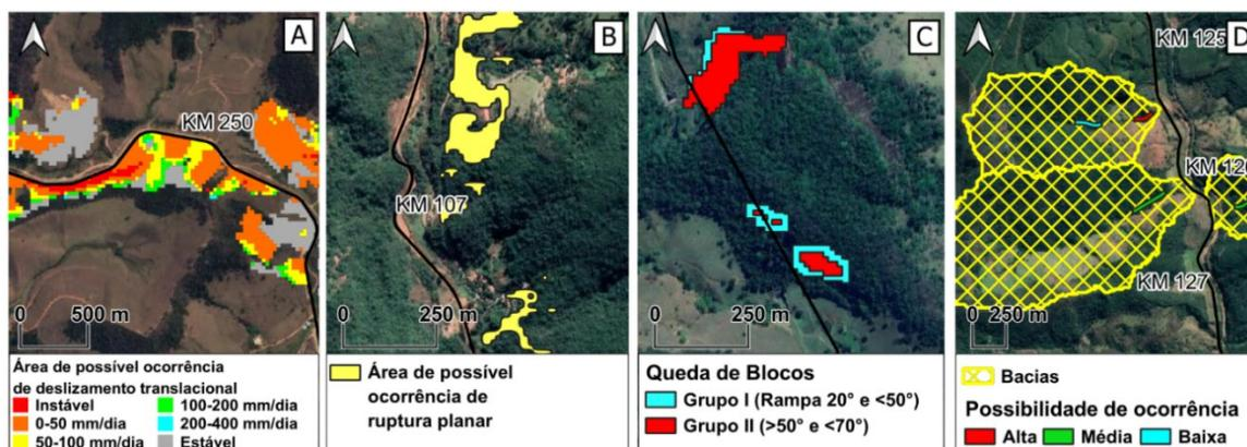
Figura 5: Recortes dos resultados das áreas suscetíveis à eventos geotécnicos com potencial dano a estrutura do mineroduto, deslizamento translacional em “A”, ruptura planar em “B”, queda de blocos em “C” e fluxo de detritos em “D”.
