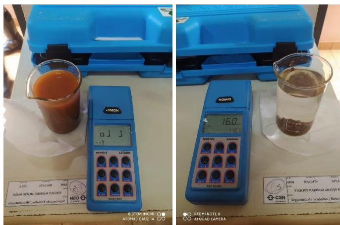
Figura 5. Análise comparativa da amostra de efluente com medida da Turbidez da amostra sem e com a aplicação do HPF.
