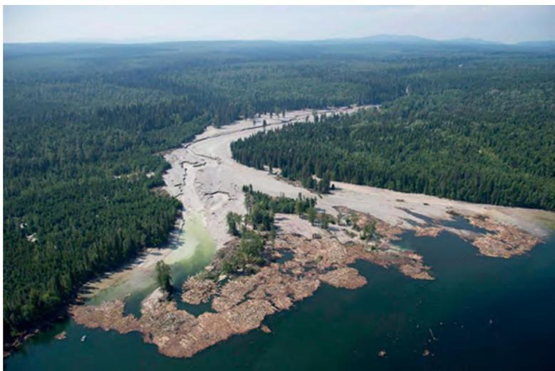
Figura 2 - Local onde barragem da mina de Mount Polley rompeu, despejando 25 milhões de metros cúbicos de rejeitos. Fonte: Canadian Centre for Policy Alternatives
