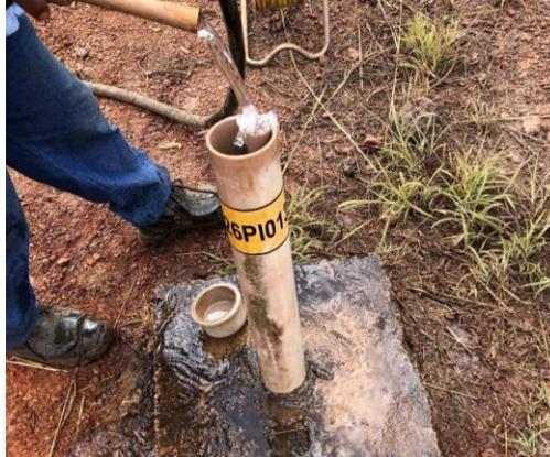
Figura 2 – Execução de Teste de Vida em piezômetro.
