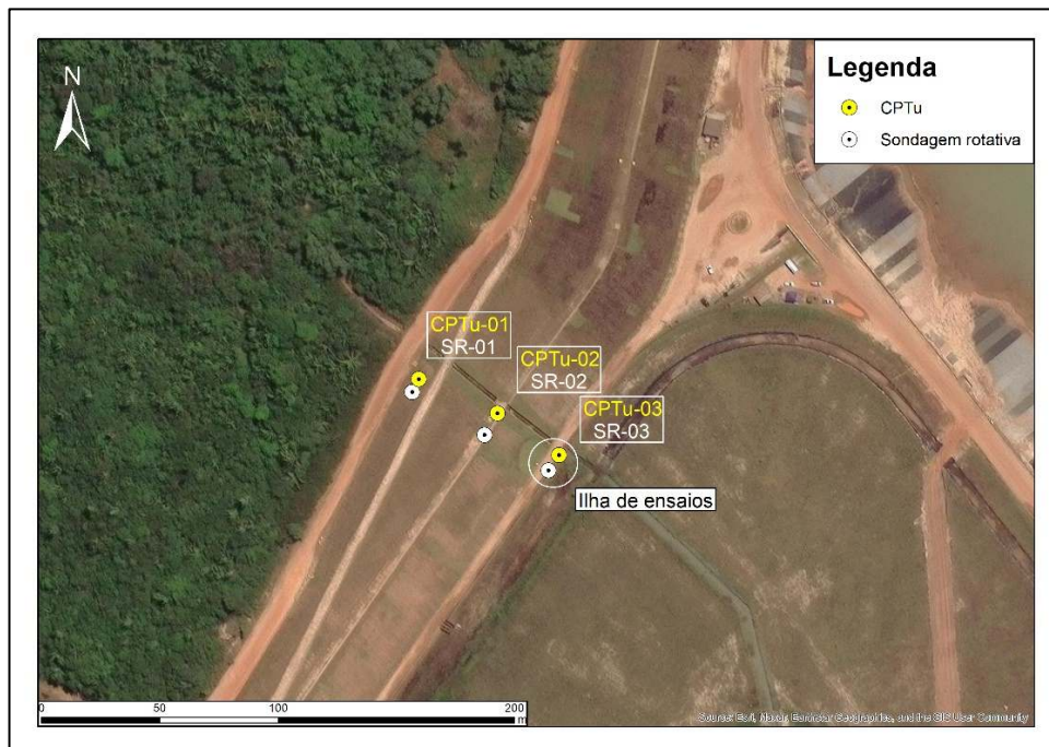
Figura 1: Ilhas de pontos. SR caracteriza sondagem rotativa com recuperação de testemunhos e CPTu define ensaio CPTu com ensaio de dissipação de poropressão.
