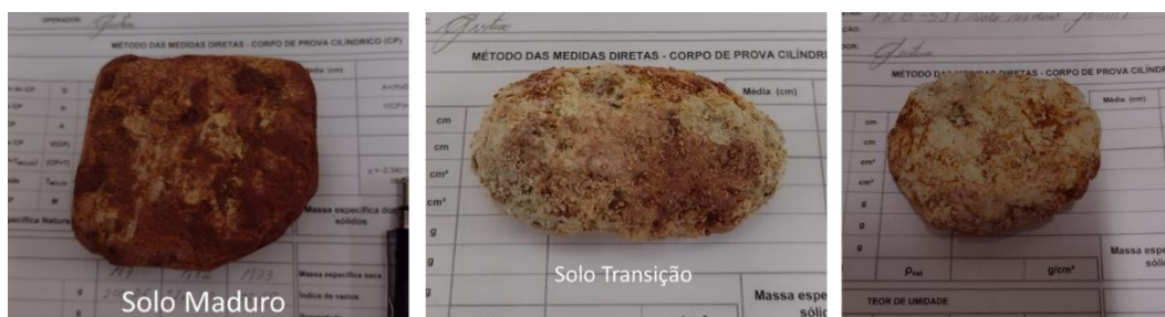
Figura 9. Preparação das amostras indeformadas para obtenção dos índices físicos.
