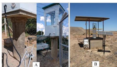
Figura 3 – Exemplos de marcos geodésicos mal (Figura A) e bem planejado (Figura B). (Fonte da Figura A: Própria & Fonte da Figura B: Thomas H.W. 2011)
