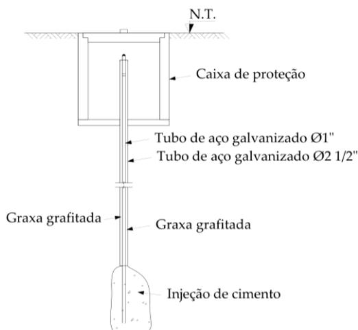
Figura 5. Desenho esquemático da referência de nível profunda.
