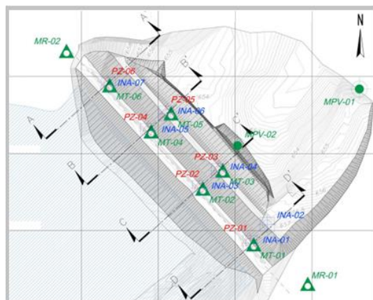
Figura 3. Planta da instrumentação
