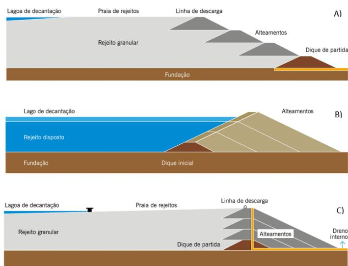
Figura 1. Métodos construtivos de barragens; A) Alteamento para montante; B) Alteamento para jusante e C) Alteamento por linha de centro (DUARTE. A. P, 2008 apud ICOLD, 2001).
