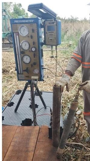
Figura 4. Posicionamento do equipamento para a realização do ensaio no campo experimental de Sarapuí II.
