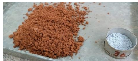
Figura 1. Amostra de solo e do 5% de estabilizante químico antes da mistura.
