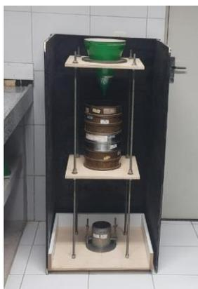
Figura 3. Equipamento de pluviação com peneiramento múltiplo.
