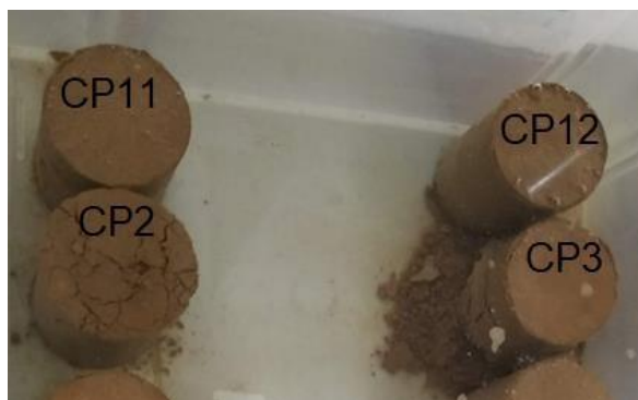
Figura 4. CPs com 2% de Cal antes da ruptura
