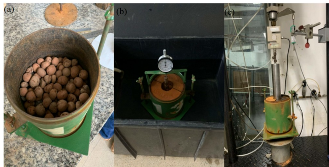
Figura 3: Ensaio de ISC. (a) Moldagem de uma amostra. (b) Amostra imersa no tanque. (c) Ruptura da amostra
