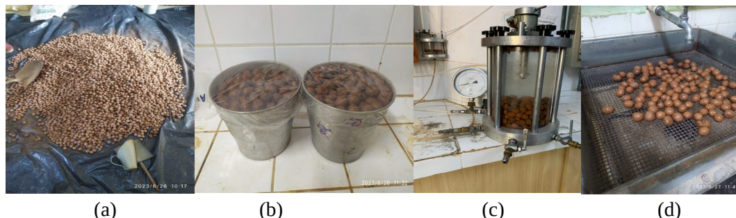
Figura 1: Argila expandida. 1(a) Homogeneização do material. (b) Absorção de água sem pressão. (c) Absorção de água com pressão de 100 kPa. (d) Amostras em peneiras após imersão em água.
