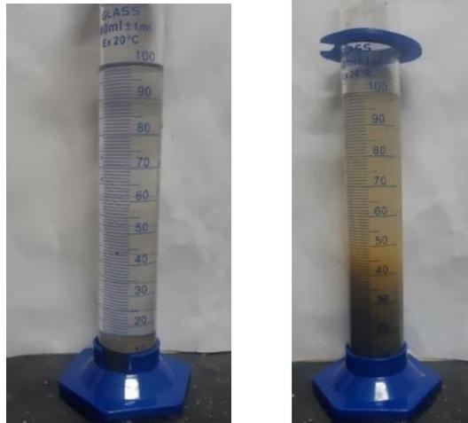
Figura 5. FSI para solo B com substituição de 18,5% CBCA (a) proveta com solo e querosene (b) proveta com solo e água.
