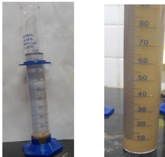
Figura 2. FSI para solo B sem adição de CBCA (a) proveta com solo e querosene (b) proveta com solo em água.
