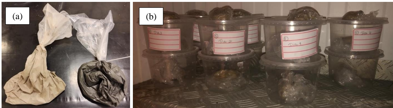
Figura 3. (a) Amostras após processo de amolgamento manual para posterior condicionamento por diferentes métodos de armazenamento: Bacia de Santos (à esquerda) e Sarapuí II (à direita); (b) Armazenamento das amostras na câmara climática pelos métodos abordados.
