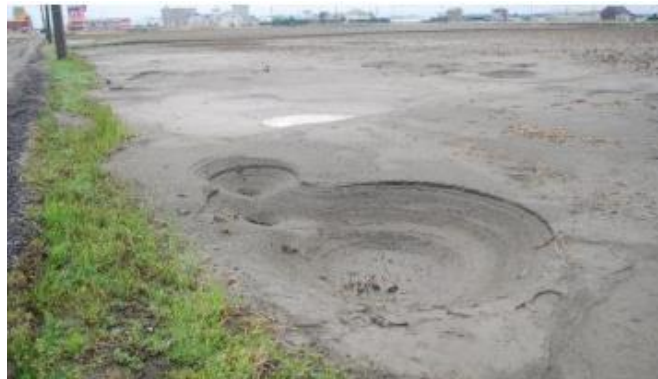
Figura 1. Liquefação em solo arenoso (Fonte: Amanda Fuccio (2019)).
