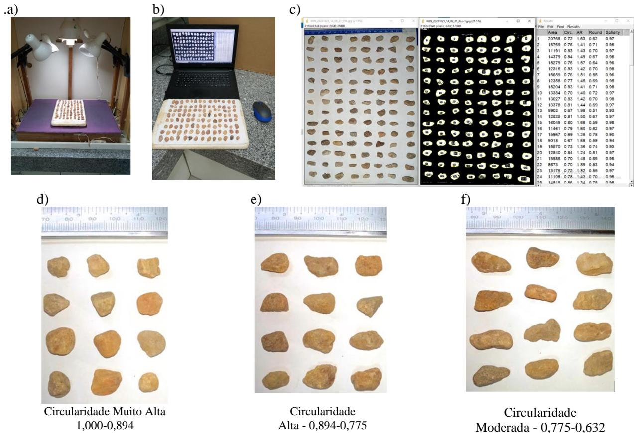
Figura 1. Avaliação da circularidade dos grãos: a) Aparato para coleta as imagens dos formatos dos grãos, b) material após a separação nas circularidades, c) imagem em formato binário e quantificação das características dos grãos, d) Circularidade Muito Alta, e) Circularidade Alta, f) Circularidade Moderada.
