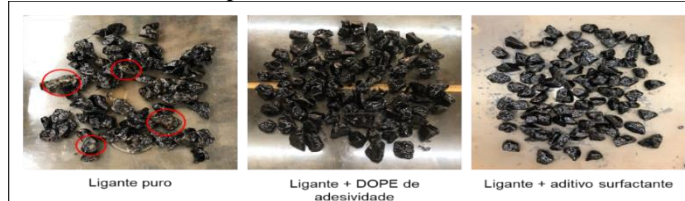
Figura 3. Ensaio visual de adesividade.
