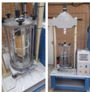
Figura 1. Prensa triaxial para ensaio dinâmico drenado.
