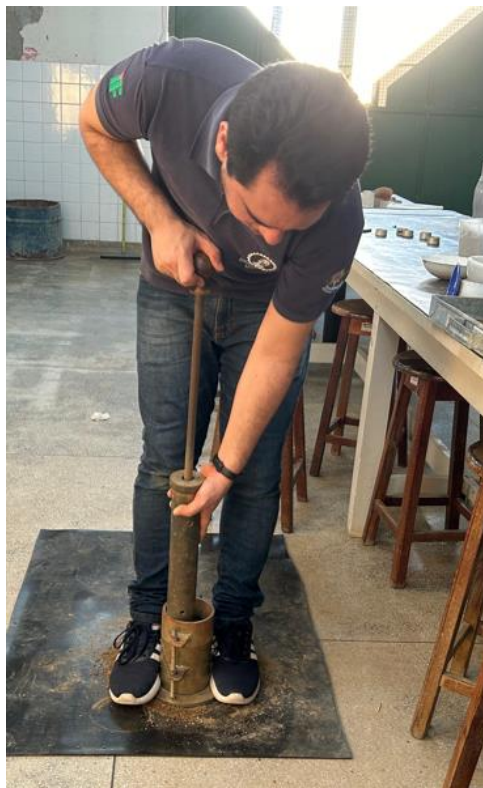
Figura 3. Realização do ensaio de compactação.
