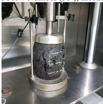
Figura 4. Ensaio de Flow Number.
