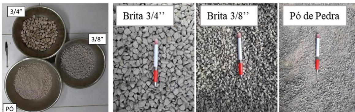
Figura 2. Frações empregadas para compor a mistura granular e materiais
