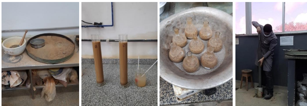
a) Destorroamento do solo de subleito. b) Sedimentação para determinação da granulometria. c) Determinação da densidade real. d) Compactação para ensaio de CBR.
