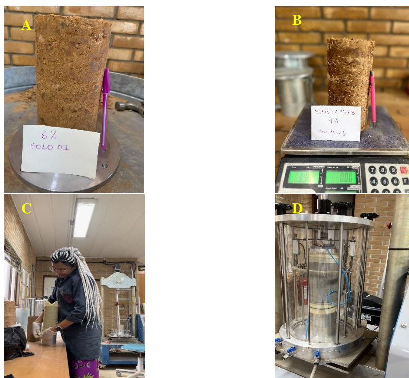
Figura 2. (A) Aspecto da amostra de solo-emulsão (B) Aspecto da amostra solo-fibra (C) Colocação da geomembrana (D) Execução do ensaio de MR.
