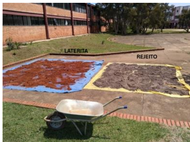
Figura 1. Processo de secagem das amostras de laterita e rejeito.
