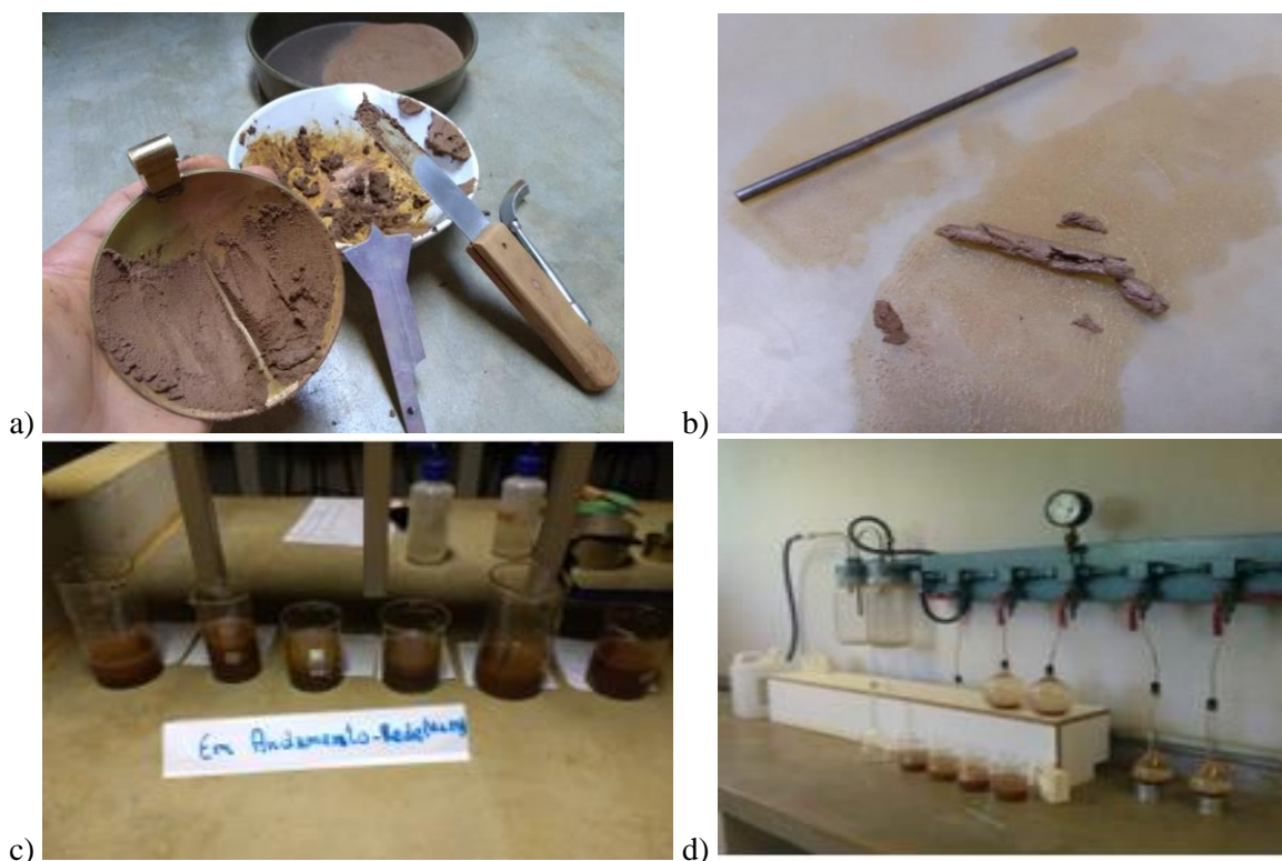
Figura 2. Ensaios realizados: a) limite de liquidez b) limite de plasticidade c) granulometria por sedimentação d) massa específica dos grãos.
