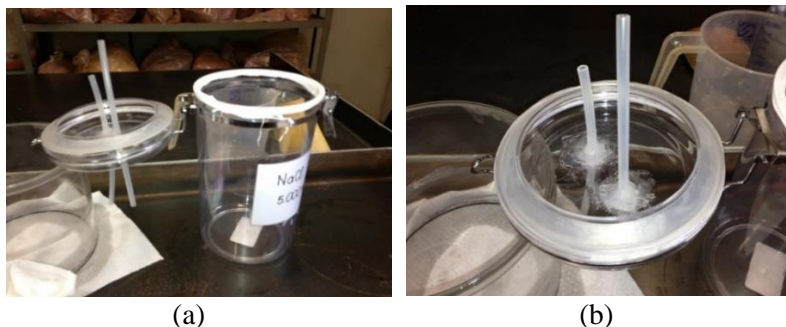
Figura 4 – Detalhes da preparação do reservatório de solução salina.
