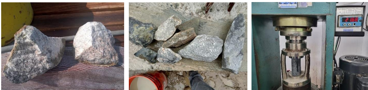
Figura 4. Amostras de gnaiss extraídas durante a perfuração das estacas da OAE 403 dos Contornos de Caraguatuba e de São Sebastião e ensaio de resistência à compressão uniaxial realizado nas amostras.
