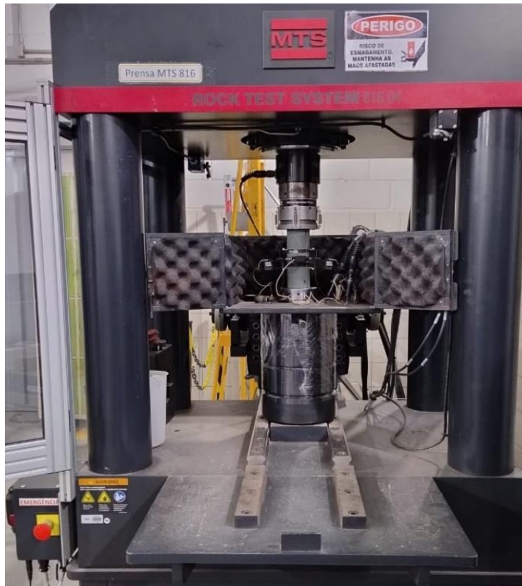
Figura 2 - Ensaio UCS com controle de deformação.
