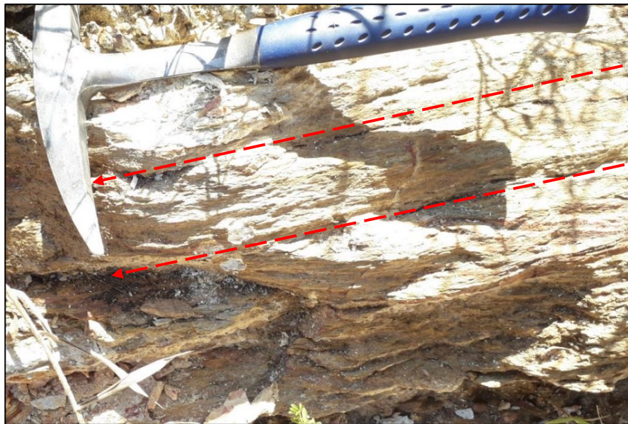
Figura 2. Xisto de coloração esbranquiçada com planos de fraqueza (xistosidade), ilustrados pelas setas vermelhas, bem-marcados
