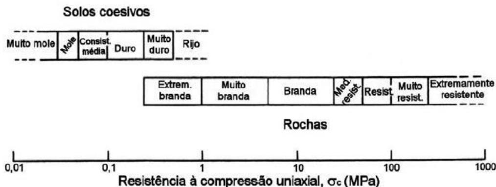
Figura 1. Resistência à compressão uniaxial em solos e rochas (ISRM, 1978)
