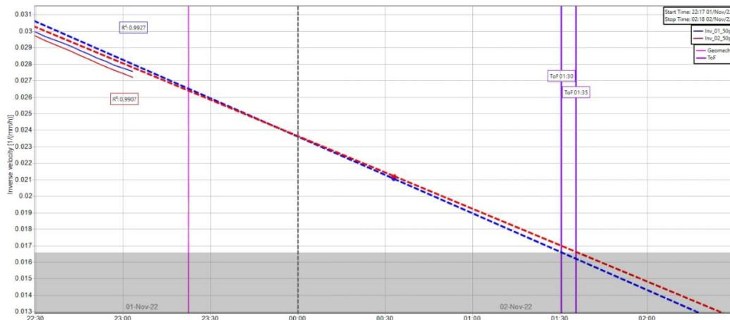
Figura 4. Gráfico do Inverso da Velocidade para as áreas de 50% com média móvel de 03:00.
