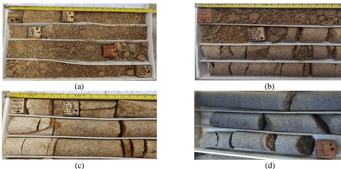
Figura 2. Testemunhos de sondagem: (a) Solo residual, (b) Rocha completamente intemperizada, (c) Rocha intemperizada e (d) Rocha não intemperizada.
