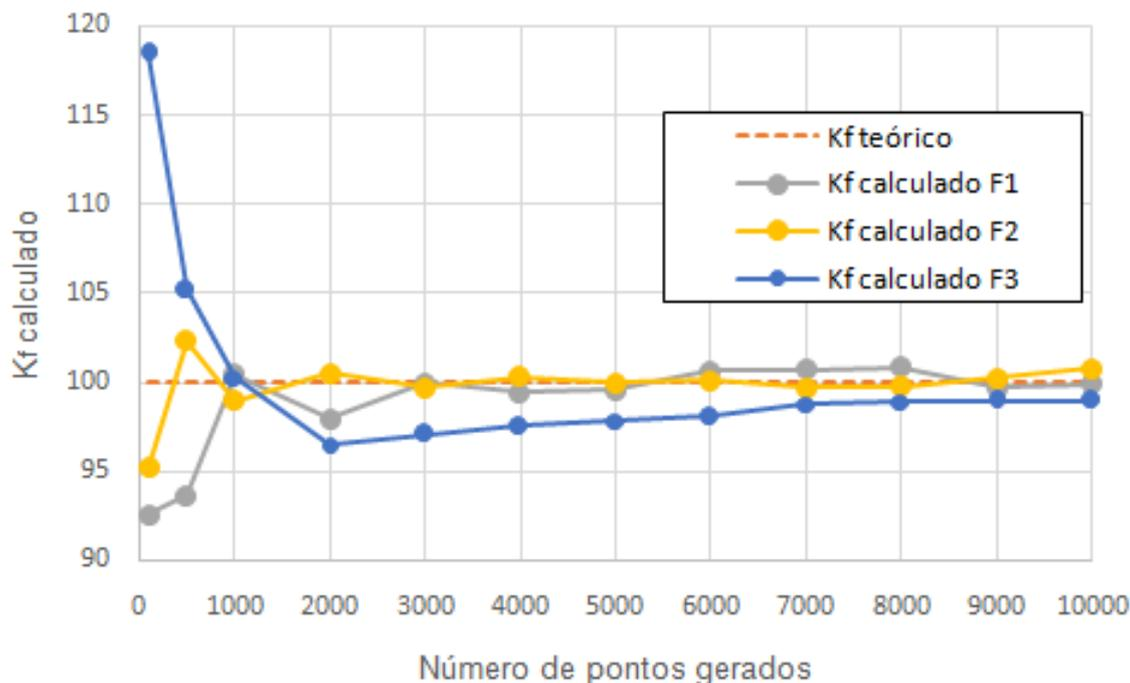
Figura 5. Valor do  $k_f$  calculado em função do número de amostras geradas, valor teórico de  $k_f = 100$ , resultados do UnWedge.
