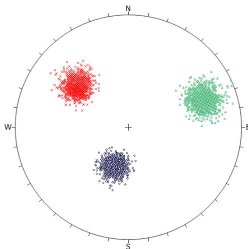
Figura 2. Polos para simulação com 1000 amostras geradas (3 famílias com 1000 amostras cada),  $k_f=100$ , formulação de Zheng *et al.* (2014).
