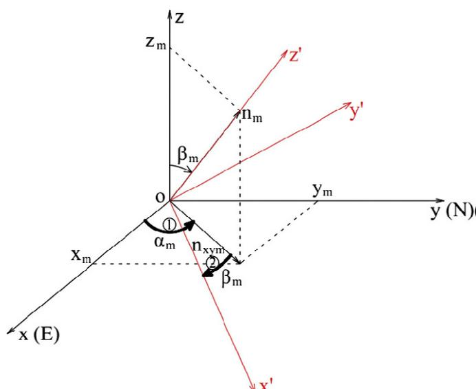
Figura 1. Sistema de coordenadas cartesianas original  $(x, y, z)$  e sistema de coordenadas cartesianas transformado  $(x', y', z')$  (Zheng *et al.*, 2014).
