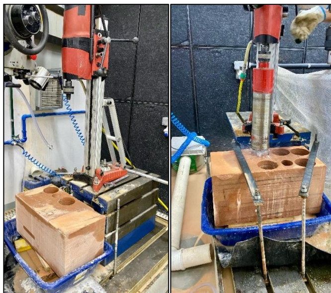
Figura 1. Retirada dos testemunhos de Arenito da Formação Botucatu.
