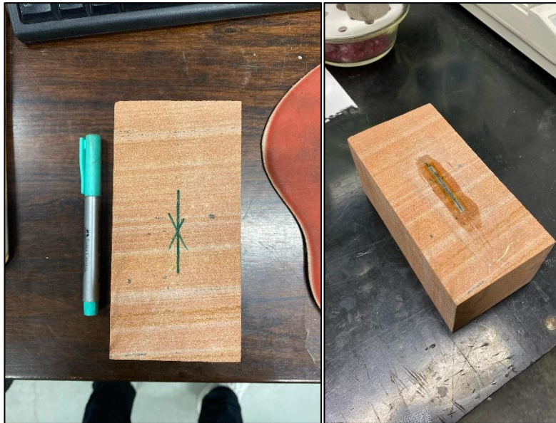
Figura 3. Instrumentação do corpo de prova – Strain gauges.
