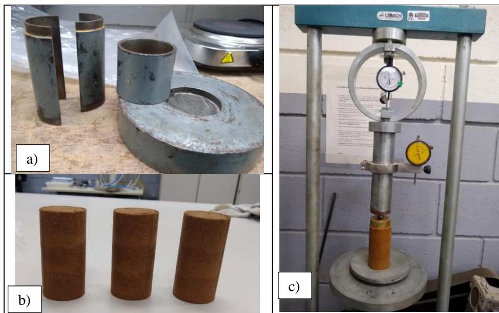
Figura 1. Molde utilizado para confecção do corpos de prova para ensaios de compressão simples (a), corpos de prova (b) e prensa para ruptura (c)
