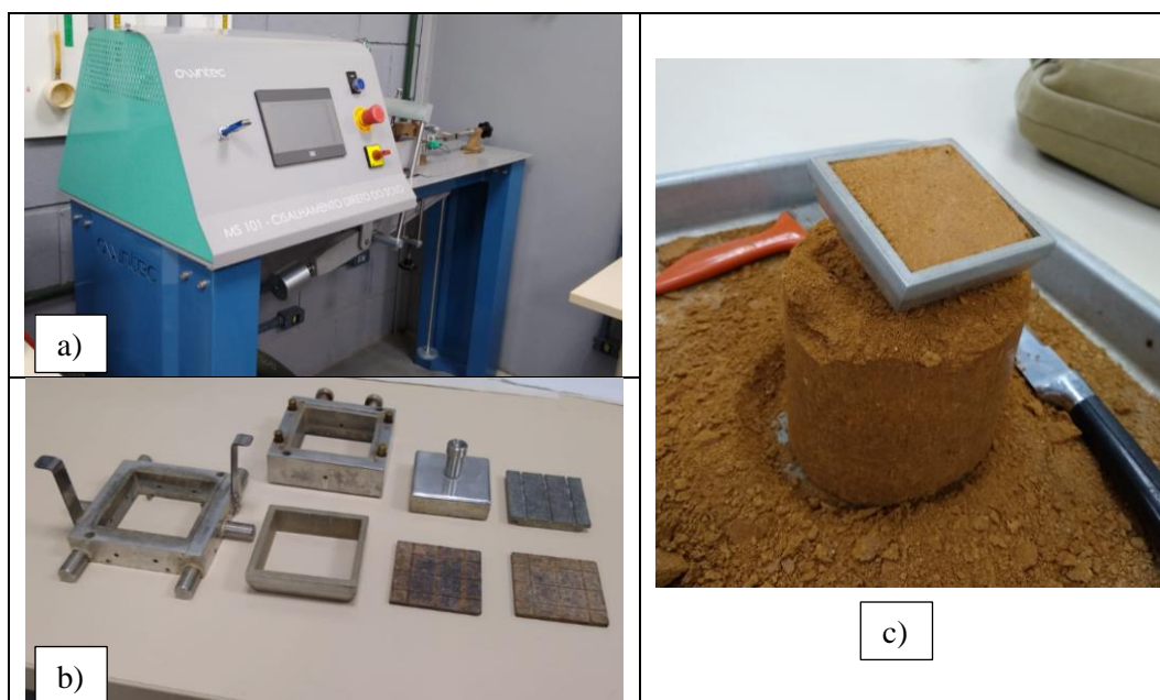
Figura 2. Equipamento do ensaio de cisalhamento direto (a), caixa de cisalhamento (b) e moldagem dos corpos de prova para o ensaio de cisalhamento direto (c)
