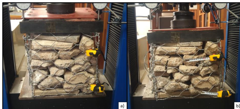
Figura 2. (a) Gabião G5 no início do ensaio, sem aplicação e carga e (b) G5 no fim do ensaio.
