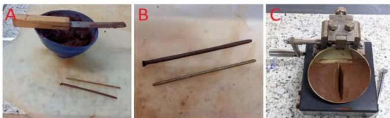
Figura 2. (A) Placa de vidro e solo utilizado, (B) Gabarito de metal e cilindro de solo, (C) Aparelho de Casagrande com a fenda no solo, Autor (2021).
