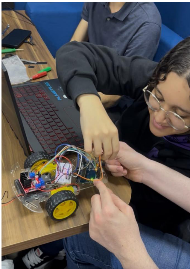
Figura 9 - Circuito eletrônico montado em protoboard e conectado à placa de desenvolvimento, utilizado para experimentação e aprendizagem de sistemas embarcados durante as oficinas de robótica.
