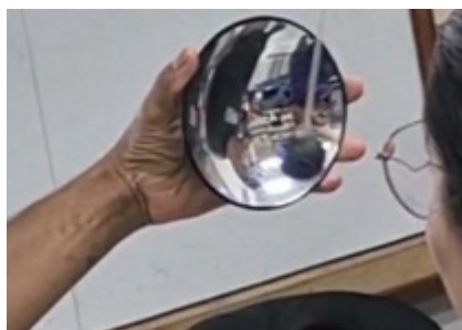
Figura 9 - Experimento formação sobre da imagem num espelho côncavo.
