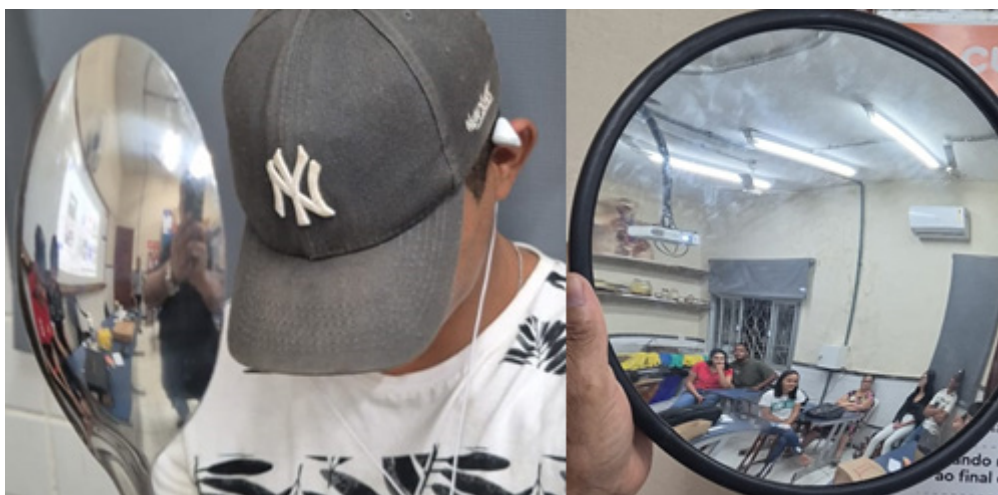
Figura 10 – Experimento sobre a formação sobre da imagem num espelho convexo.
