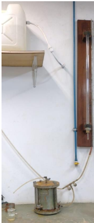
Figura 1 – Sistema de montagem dos ensaios de permeabilidade
