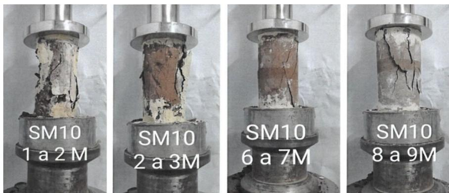
Figura 4. Aspecto dos corpos de prova das amostras indeformadas após rompimento.
