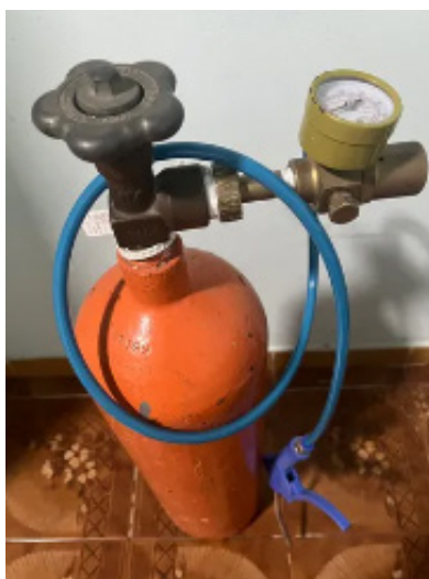
Figura 6: Cilindro de gás com válvula reguladora de pressão.
