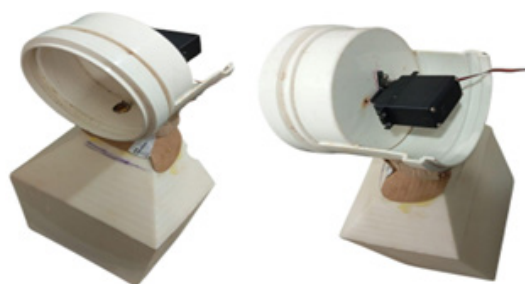
Figura 5: Versão otimizada do protótipo após a substituição de componentes por estruturas em PVC reciclado.
