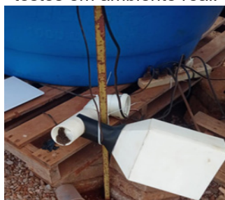
Figura 4: Protótipo instalado no sistema de aquaponia evidenciando a instabilidade estrutural durante os testes em ambiente real.
