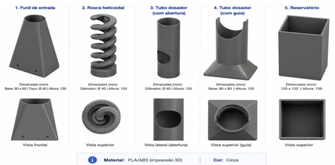
Figura 2: Projeto tridimensional dos componentes do alimentador automático desenvolvido no software Autodesk Fusion 360.
