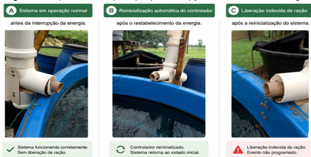
Figura 6: Comportamento do protótipo após interrupção do fornecimento de energia.
