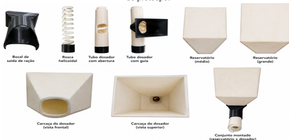
Figura 3: Componentes do alimentador automático produzidos por impressão 3D e utilizados na montagem do protótipo.
