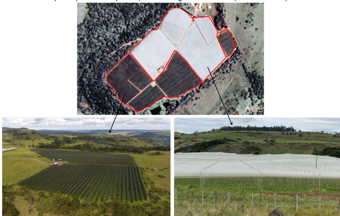
Figura 3. Validação em campo da resposta espectral de pomares de macieira. Na imagem orbital (topo), delimitada em vermelho, observa-se o contraste radiométrico entre pomares cobertos por tela antigranizo preta (inferior esquerdo) e tela antigranizo branca (inferior direito).
